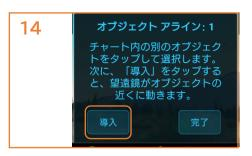
他にも明るい星が見える場合には、その星 をSkyPortalアプリの画面でタップすると 導入ボタンが表示されますので、導入ボタ ンをタップします。望遠鏡がその星の近く まで自動で動きますので、上下・左右キー をタップしてスターポインターファインダ - の赤い光点と重なったらEnterをタップ し、明るい星が25mm接眼レンズの中心に きたら同期をタップします。ここで完了を タップするとアライメントが不完全ですと 表示されますが、OKをタップします。追 尾が開始されます。2星でのアライメント になりますので、1星でのアライメントよ り導入精度は上がります。3星目が見える 場合は、SkyPortalアプリの画面でタップ し同様の操作を行います。
