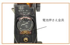
注意:電池押さえ金具をボタン電池で抑え込まないでください。 必ず挟込んでください。
