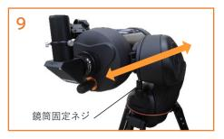
バランスを調整したり、架台フォークアームから鏡筒を取外すには、鏡筒固定ネジを緩めて、鏡筒を接眼部方向にスライドさせます。鏡筒の取付け、取外しの際は、鏡筒をしっかりと持ってください。鏡筒を外す前に、プレートホルダーの鏡筒固定ネジが締まっていることを確認してください。
