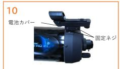
スターポインターファイダーの側面にある 固定ネジを緩め、アリミゾ式ブラケットに スライドさせます。固定ネジを締めて固定 します。電池カバーの下にある小さなプラ スチックのタブを引き、電池が接触するよ うにします。(プラスチックタブの付いて いない機種もあります)
