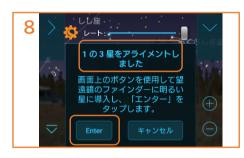
アライメントが1星完了したので、画面表示が1の3に変わりました。2つ目の明るい星を先程と同じようにスターポインターファインダーの光点と重ねます。2つめの明るい星は1つ目より90度以上離れている星をお選びください。重なったらEnterをタップします。
