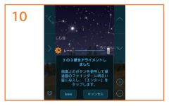
3つ目の明るい星は、1・2つ目の星と直線にならない明るい星を選んでください。 大きな三角形を作る星をお選びください。 1・2つ目の星と同じように、スターポインターファインダーの光点に明るい星を 重ねてEnterをタップし、25mm接眼レンズの中心に明るい星がきたら同期をタップします。アライメントが成功しましたと表示されたらアライメント終了です。
