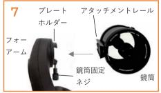
鏡筒のアタッチメントレールをフォークアームのプレートホルダーに配置して、望遠鏡の鏡筒を取付けます。アタッチメントレールの底がプレートホルダーに対して平らになっていることを確認してください。鏡筒固定ネジをしっかりと締めます。
