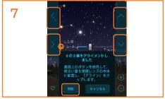
次に25mm接眼レンズを覗き、明るい星が 視野の中央にくるように上下・左右キーを 押して調整します。視野の中心に星を移動 させている時は望遠鏡の動きがゆっくりに なります。明るい星が視野の中心にきたら 同期をタップします。
