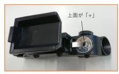
新しいCR2032電池をプラス側が上に見 えるように挿入します。電池フタを再度 取付けます。
