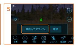
接続してアラインをタップします。望遠鏡が天体を正確に導入するためには、まず望遠鏡に実際の空のどの星に向いているかを教える必要があります。これをアライメント(アライン)といいます。SkyPortalアプリでは、明るい星を3つ導入して望遠鏡がどこを向いているかを教えます。
