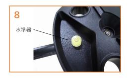
初期設定の為、三脚を水平にする必要があります。水平を確認するには、別途水準器をご準備いただき三脚の上に置いてください。必要に応じて各脚の高さを水準器を確認しながら調整し、水準器の泡が赤丸の中に入っているのを確認します。終わったら水準器を外してください。
