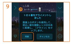
2つ目の明るい星が25mm接眼レンズの中心にくるように上下・左右キーを押します。中心にきたら同期をタップします。
