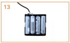
電池ボックスから電池収納ケースを取出し フォークアームの 単3形乾電池8本を電池収納ケースにセット をオンにします。 します。電池ボックスに再び収納します。 電池の極性に注意して挿入してください。 注:冬場の乾電池での観測はすぐに電池切れを起こします。別売のPower Tank Lithi umなどの外部バッテリーをご使用ください。
