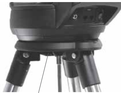
3つの取付けボルトのうちの1つ
