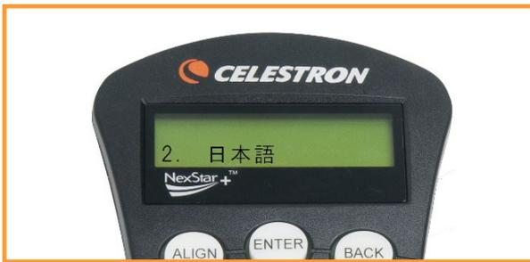
しばらくすると[ (機種名) ]と表示され、[enterを押してアライメントを始めます]と表示されるので、ENTERキーを押し、アライメント方法を選択します。
