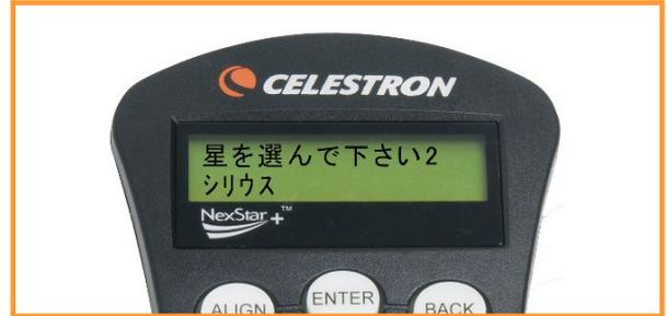
8.▲/▼/▶/◀ (方向) キーを使用して、ファインダーの中心に基準星2を導入し、ENTERキーを押します。
