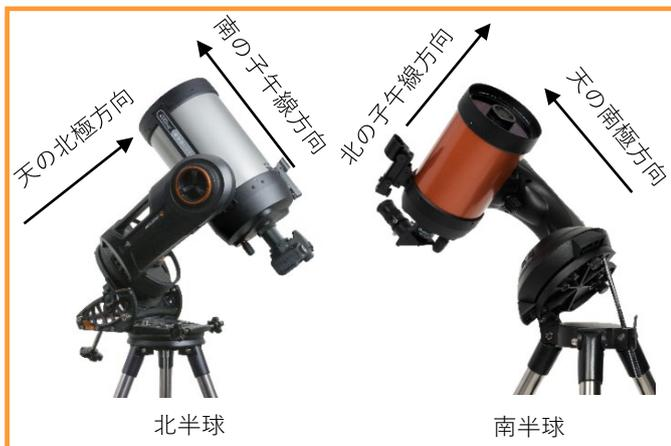
赤道儀アライメント機能を使用するには、望遠鏡架台をオプションのウェッジに取付ける必要があります。ウェッジを使用した極軸合わせを行う最も簡単な方法は、ウェッジの傾斜プレートに角度をつけ、フォークアーム（または極軸）が北極星に向くようにします。
