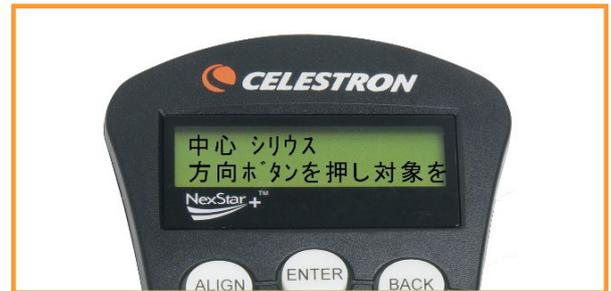
8.▲/▼/▶/◀（方向）キーを使用して、接眼レンズの中心に基準星を導入して、ALIGNキーを押します。
