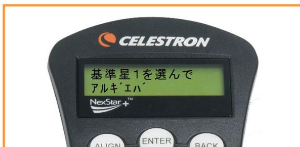
5.▲/▼/▶/◀ (方向) キーを使用して、望遠鏡を基準星の方向に向けます。
