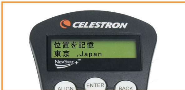
時刻と場所の表示は、GPSとリンクしているとき入力され、最後に保存された時刻と場所を常に表示します。GPSの情報が受信されると、表示されている情報が更新されます。GPSがオフになっているか SkySync GPSを取付けていない場合、ディスプレイには最後に保存された時刻と場所を表示します。
