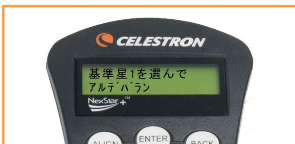
4.▲/▼/▶/◀ (方向) キーを使用して、望遠鏡を基準星の方向に向けます。
