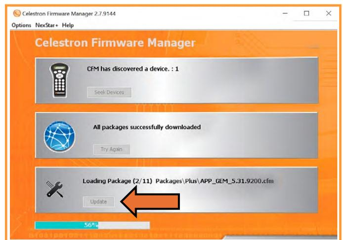
警告：アップデート中は、ハンドコントローラを外したり、コンピュータや架台の電源をOFFにしたりしないでください！
