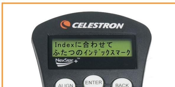
2.Advanced VX赤道儀では[Indexに合わせて]と表示されるので、赤経軸・赤緯軸にある印（インデックス）を合わせ、ENTERキーを押します。CGX赤道儀やCGX-L赤道儀では、センサーが内蔵されていますので、自動的に望遠鏡がホームポジションに向きます。
