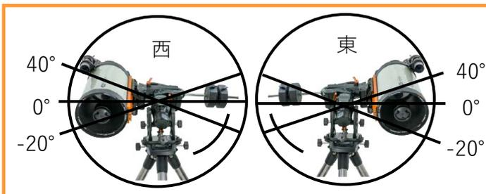
警告：望遠鏡がギアのバックラッシュ量を最小にする方向から星に導入できるようにするには、望遠鏡が正しい方向から星に近づくために、指定された導入制限を超えて導入する必要がある場合があります。望遠鏡の導入方向を変更するには、[スコープセットアップ]の[GOTOアプローチ]を参照してください。
