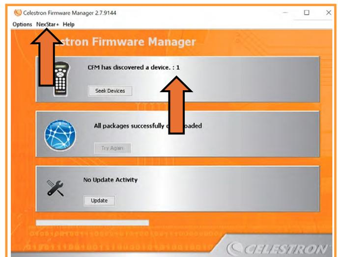
CFM がハンドコントローラを自動的に検出しない場合は、ケーブル接続を確認し、CFM の [Seek Devices] をクリックします。CFM がハンドコントローラを検出すると、ハンドコントローラに「BOOT LOADER Serial Pass Through OFF」と表示されます。
