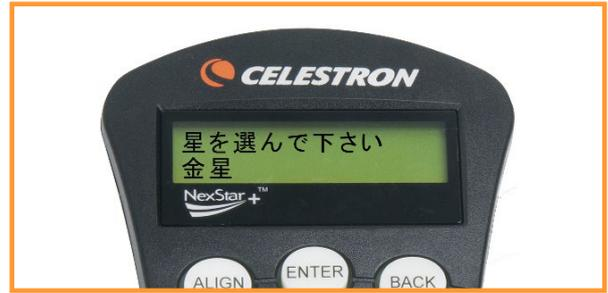
5.望遠鏡が自動的に選択した惑星や月、太陽の方向に向かって動き出します。選択した惑星や月を▲/▼/▶/◀(方向)キーを使用して、ファインダーの中心に導入し、ENTERキーを押します。**ファインダーで直接太陽を覗かないでください。**
