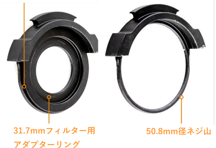
図16：引出しの 31.7mm フィルター用アダプターリングを外し、50.8mm フィルターのネジ山を露出させます。
