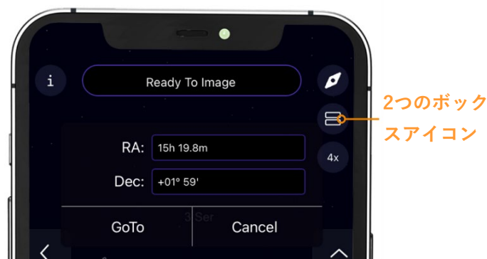
図25：望遠鏡コントロールの表示が選択されている場合、2つのボックスアイコンを押すと、手動座標インターフェイスが表示されます。
