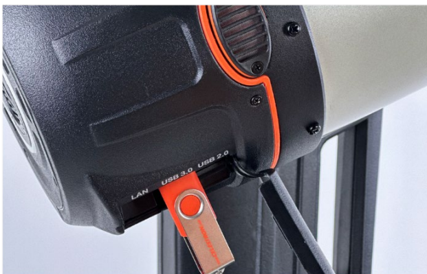
図27： Origin Intelligent Home Observatory鏡筒のUSBポートにUSBメモリを挿入し、RAW画像ファイルを転送します。
