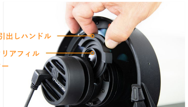
図15：引出しのハンドルを指でつかみ、外側に引いてマグネットから外します。
