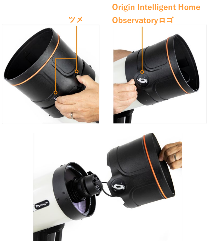
図13：Origin Intelligent Home Observatoryロゴの下を上向きに押しながら、片手で2つのツメを押し下げ、レンズフードを取り外します。
