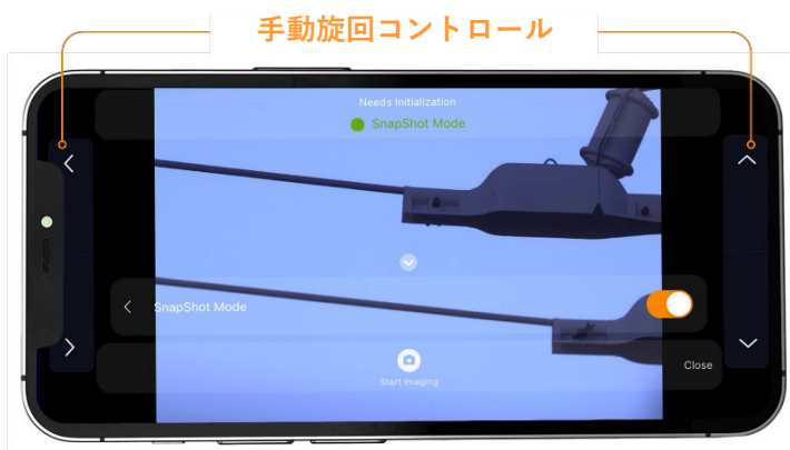
図23：スナップショットモードでは、カメラビューで望遠鏡の手動旋回コントロールにアクセスできます。これらは、デバイスを横向きにした状態で最適に機能します。
