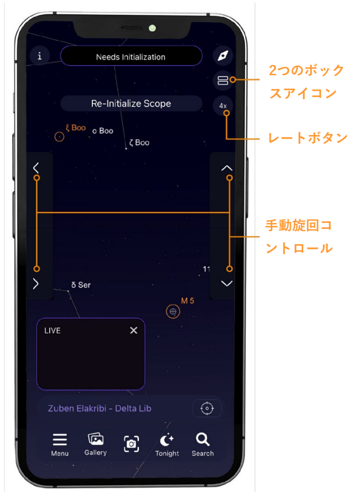
図24：望遠鏡コントロールの表示は、プラネタリウム画面での手動旋回コントロールを行うことができます。旋回レートを変更するには、レートボタンを使用します。
