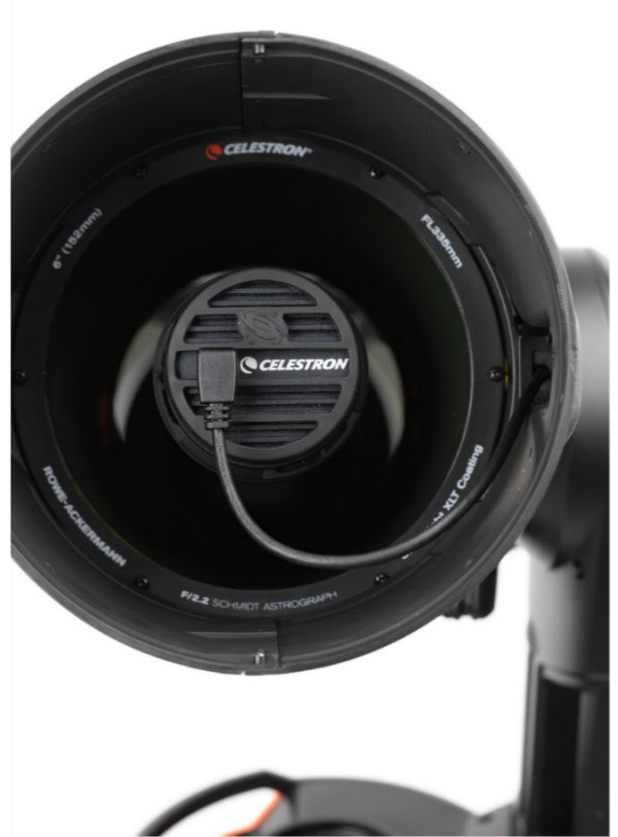
図29：工場で撮影され、Origin Intelligent Home Observatoryにプリロードされたフラットフレームは、カメラが図の向きで撮影されたものです。この向きからカメラを回転させると、新しいフラットフレームを作成する必要があります。
