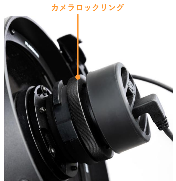
図30：カメラの向きを回転させたい場合は、まずカメラロックリングを緩めます。
