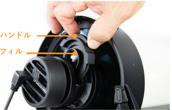
図15：引出しのハンドルを指でつかみ、外側に引いてマグネットから外します。
