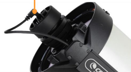
図36：カメラケーブルの片方はカメラに差込みます。もう片方はOrigin Intelligent Home ObservatoryのUSBポートに差込みます。
