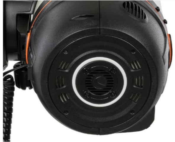
図8：Origin Intelligent Home ObservatoryのリアセルにあるLEDリングは、ステータスが一目でわかるようになっています。
