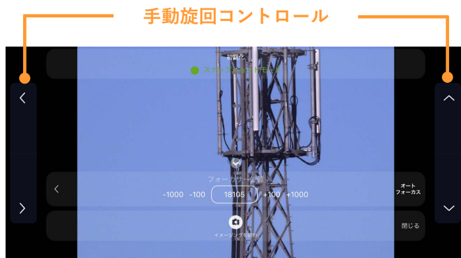
図23：スナップショットモードでは、カメラビューで望遠鏡の手動旋回コントロールにアクセスできます。これらは、デバイスを横向きにした状態で最適に機能します。
