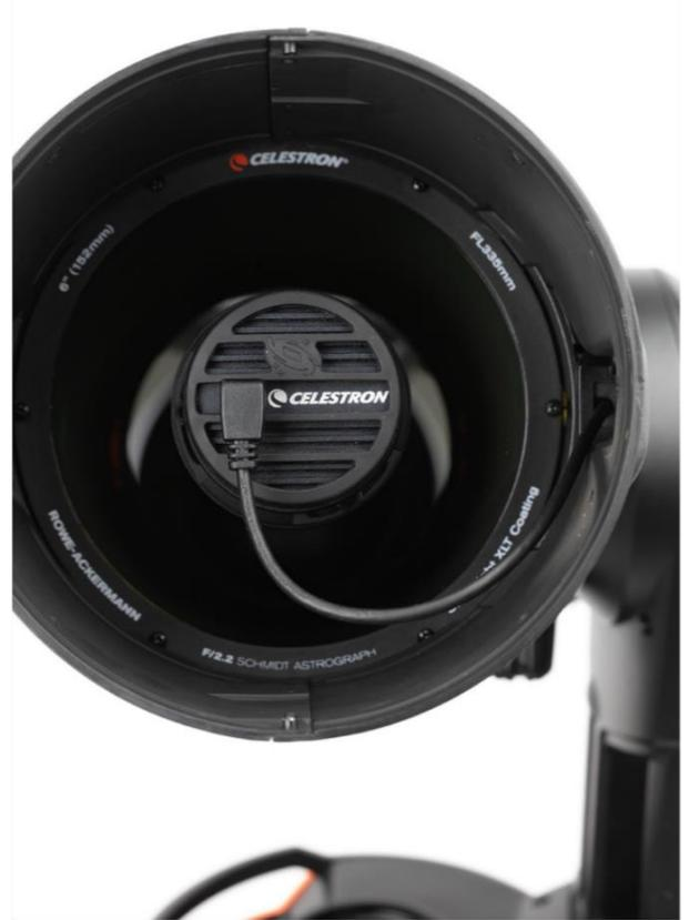
図29：工場撮影され、Origin Intelligent Home Observatoryにプリロードされたフラットフレームは、カメラが図の向きで撮影されたものです。この向きからカメラを回転させると、新しいフラットフレームを作成する必要があります。
