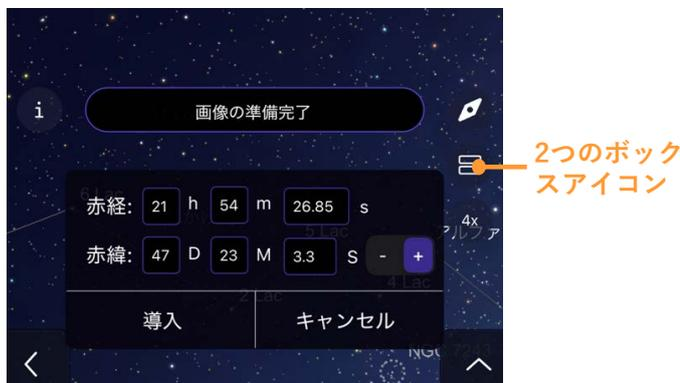
図25：望遠鏡コントロールの表示が選択されている場合、2つのボックスアイコンを押すと、手動座標インターフェイスが表示されます。
