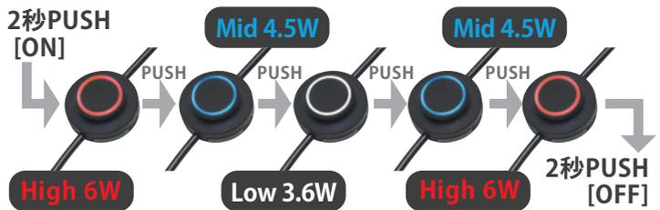
※インジケーターを点灯したくない場合は、コントローラーを併用せず、ヒーター本体に直接繋いで使用することもできます。但し、この場合は常時最大消費電力(6W)で動作します。
