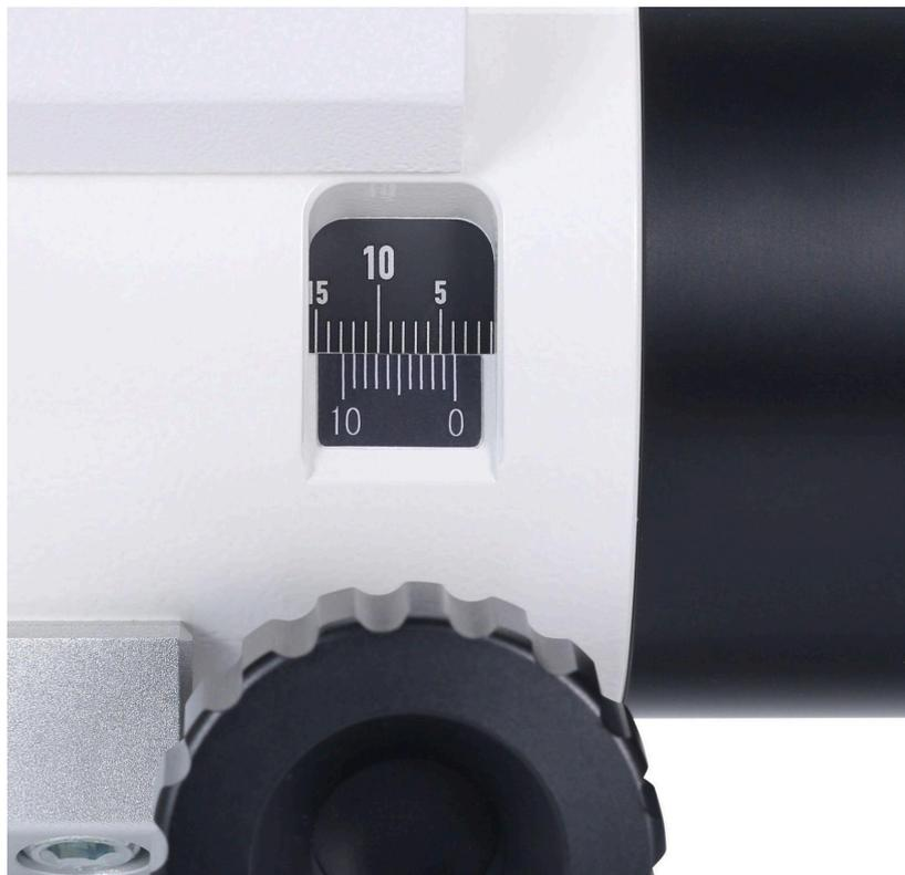
ピント位置の目安となる目盛を装備しています。バーニヤ目盛搭載により、0.1mm単位で読み取ることができます。
