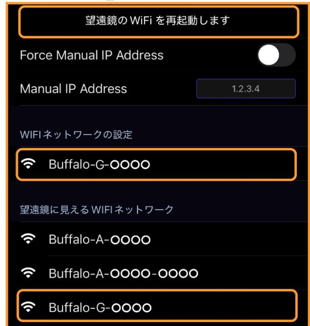
3. [望遠鏡のWiFiを再起動します] をタップします。50秒程お待ちください。再度、Origin Intelligent Home ObservatoryがSSIDと接続を試みます。初期化が始まれば、ネットワーク接続モードでの接続が成功です。
