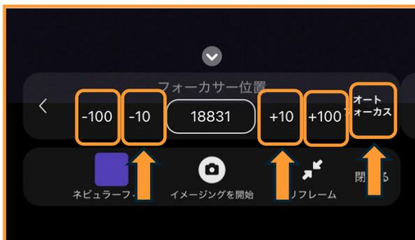
ピントを微調整する場合は [+10] や [-10] をタップしてスマートフォンやタブレットの画面で確認してください。画像をピンチアウトして拡大すると確認がしやすくなります。ピントが分かりにくくなった場合には [オートフォーカス] をタッチするとピント調整されます。
