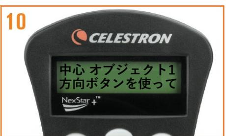
10 接眼レンズを覗くと、目標の明るい天体が接眼レンズの視野の中に見えます。見えない場合は、ハンドコントローラーの方向キーを押して視野の中に明るい天体を導入します。スピードが速く導入が難しい場合は、ハンドコントローラーのMOTOR SPEEDボタンを押し、数字キーの5や6を押します。明るい星が視野の中心に導入できたらALIGNを押します。
