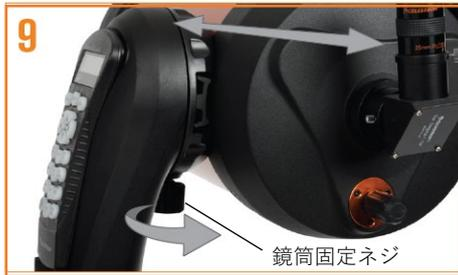
バランスを調整したり、架台フォークアームから鏡筒を取外すには、鏡筒固定ネジを緩めて、鏡筒を接眼部方向にスライドさせます。鏡筒の取付け、取外しの際は、鏡筒をしっかりと持ってください。鏡筒を外す前に、プレートホルダーの鏡筒固定ネジが締まっていることを確認してください。
