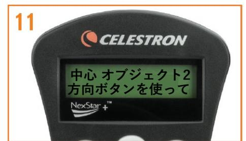
11 2つ目のアライメントの明るい星は、1つ目の明るい星からなるべく離れた場所にある明るい星や惑星を選びます。90度以上離れている明るい天体を選んでください。先程と同じように、方向キーで2つ目の明るい星をスターポインターファインダーの赤い光点に合わせ、ENTERを押します。接眼レンズの中心に2つ目の明るい星を導入したらALIGNを押します。
