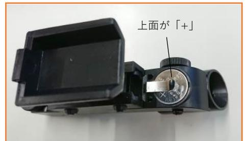
下からプラスネジで電池フタを固定しているタイプもあります。新しいCR2032電池をプラス側が上に見えるように挿入します。電池フタを再度取付けます。
