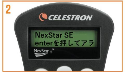
ディスプレイに「NexStar SE」と表示されます。ENTERを押して、アライメント手順を開始します。
