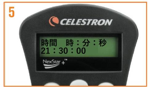
5 数字テンキーを使って、現在の時刻を入力します。入力が完了したらかENTERを押して続行します。12時間形式で時間を入力した場合は、AMまたはPMを選択する必要があります。SCROLLボタン（▲6か▼9）で選択したらENTERを押します。
