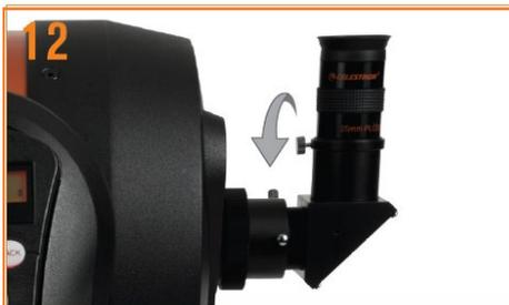
25mm接眼レンズのキャップを外し、25mm接眼レンズのスリーブを天頂ミラーに差込みます。止めネジを締めて固定します。
