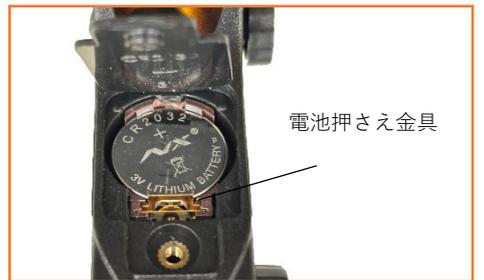
注意：電池押さえ金具をボタン電池で押え込まないでください。必ず挟込んでください。
