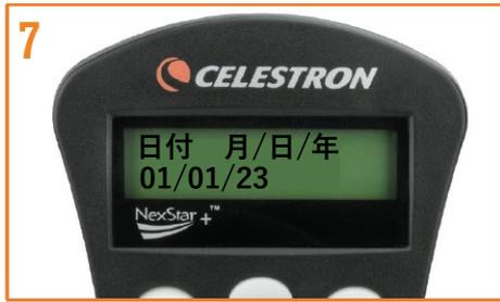
7 数字テンキーを使って、今日の日付を月/日/年の形式で入力します。2023年1月1日は「01/01/23」と入力します。入力したらENTERを押します。スカイライメントを開始します。ENTERキーを押します。
