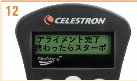
3つ目の明るい星についても、この手順を繰り返します。望遠鏡が3つ目の星にアライメントされると、ディスプレイには「アライメント完了」と表示されます。BACKボタンを押すとアライメントした3つの明るい星の名前が表示されず、ENTERを押してアライメントを終了します。スカイアライメントが失敗する時は、三脚が水平になっているかハンドコントローラーの入力で月/日/年の順番になっているか確認してください。また、3つの明るい星は、天頂付近の星は選ばない、地平線付近の星は選ばない、3つの星が直線にならない様に大きな三角形を描く星を選ぶ、月は面積が大きいのので選択しない、をご確認ください。
