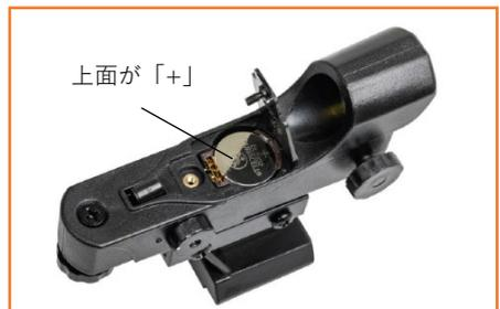
電池が取り出しにくい場合は、マイナスドライバーや先の細い物で取出してください。新しいCR2032電池をプラス側が上に見えるように挿入します。電池フタを開けてプラスネジを締めます。
