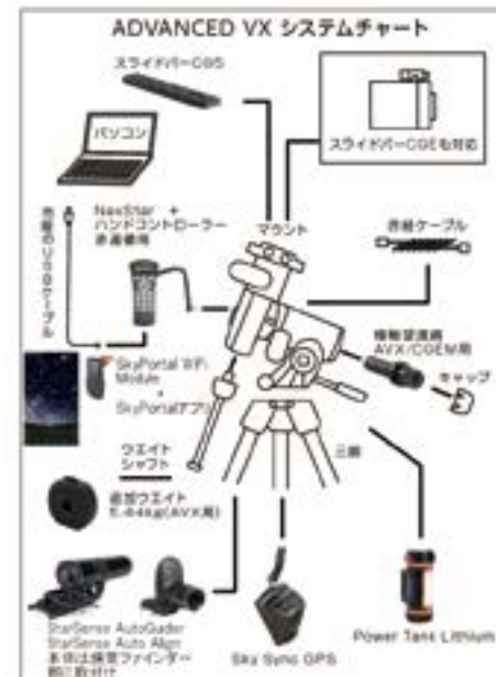
※NexStar + ハンドコントローラー赤道儀用と SkyPortal WiFi Moduleの共用は不可
