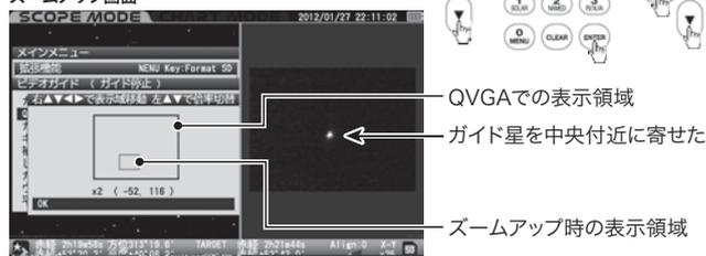
左画面のカーソルはQVGA画面内の拡大している箇所を表します。右の画面(CCDカメラの映像)は表示されている領域です。右の画面を見ながらガイド星が画面の中央に入るように調整してください。
