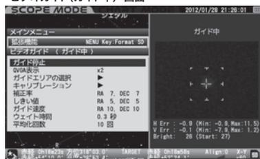
H Err:ビデオ信号の水平方向ガイドエラー量(単位:ピクセル)
