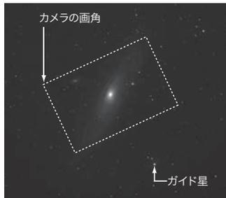
す。STAR BOOK TENコントローラーのモニター画面を確認しながら**ガイドマウントを操作し**、ガイド星がQVGA画面のほぼ中央に入るまで位置を修正します。この修正はできるだけ正確に行ってください
