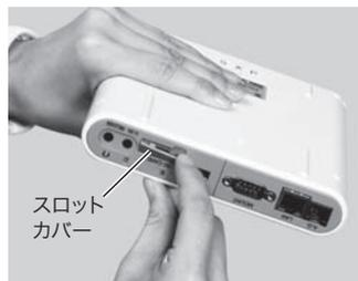
②SD/SDHCメモリーカードを接点が下になるように持ち、接点側から写真のように挿入します。
